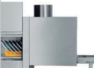
Este módulo opcional de 600 mm utiliza aire a 70°C procedente del exterior y calentado por un intercambiador de 6 kW. Un turboventilador radial envía el flujo a dos bocas superiores.
