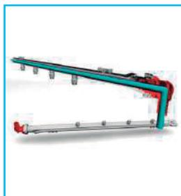
Cada brazo lleva 12 orificios para la salida del agua. Con este diseño se genera una cortina de agua formada por lamas de agua extremadamente estables y muy próximas unas de otras, de modo que las lamas de agua realizan la función de un verdadero estropajo hidráulico que arranca eficazmente la suciedad del plato.
